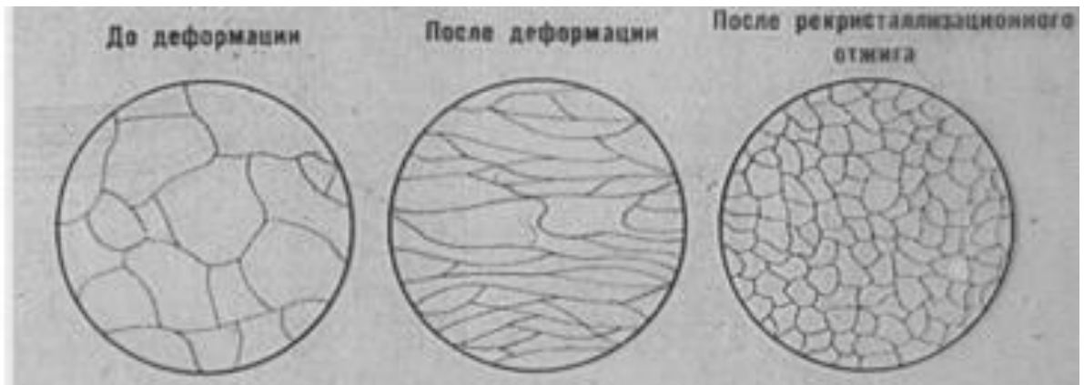
Рисунок 8.15 – Схема впливу пластичної деформації і рекристалізації на мікроструктуру сталі
