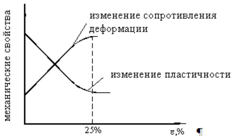
Рисунок 8.14 – Зміна механічних властивостей металу при холодній деформації
